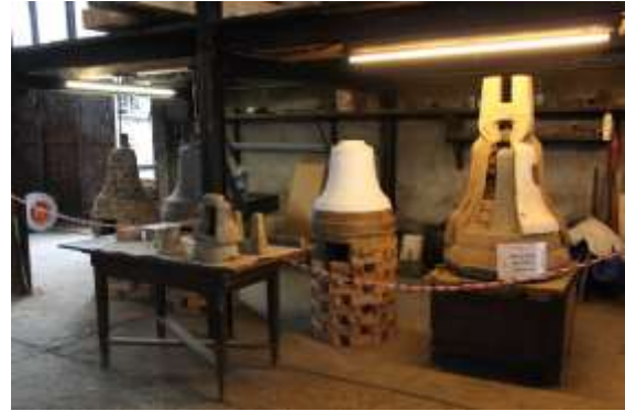
4 stadia in het maken van de gietvorm van een klok.
